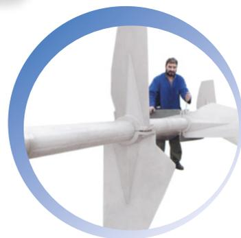
Вертикальные мешалки GFL, приводимые в действие зубчатым мотор-редуктором с параллельными валами, работают на малых скоростях вращения, позволяя использование перемешивающих элементов с большой лопастной площадью и достигая высокой производительности.
