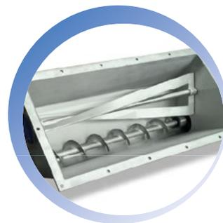
Насосы FL--ERTA с питательным желобом и подающим механизмом дополняют гамму насосов объемного действия, обладая возможностью охватывания более широкого спектра сфер применения. Фирма INOXMIM разработала данные аппараты в целях оптимизации переливания текучих тел, имеющих тенденцию к сжиманию и образованию сводов, они включают в себя систему червяка и подающего механизма, предотвращающую образование каналов и способствует перемешиванию твердых тел с жидкостями.
